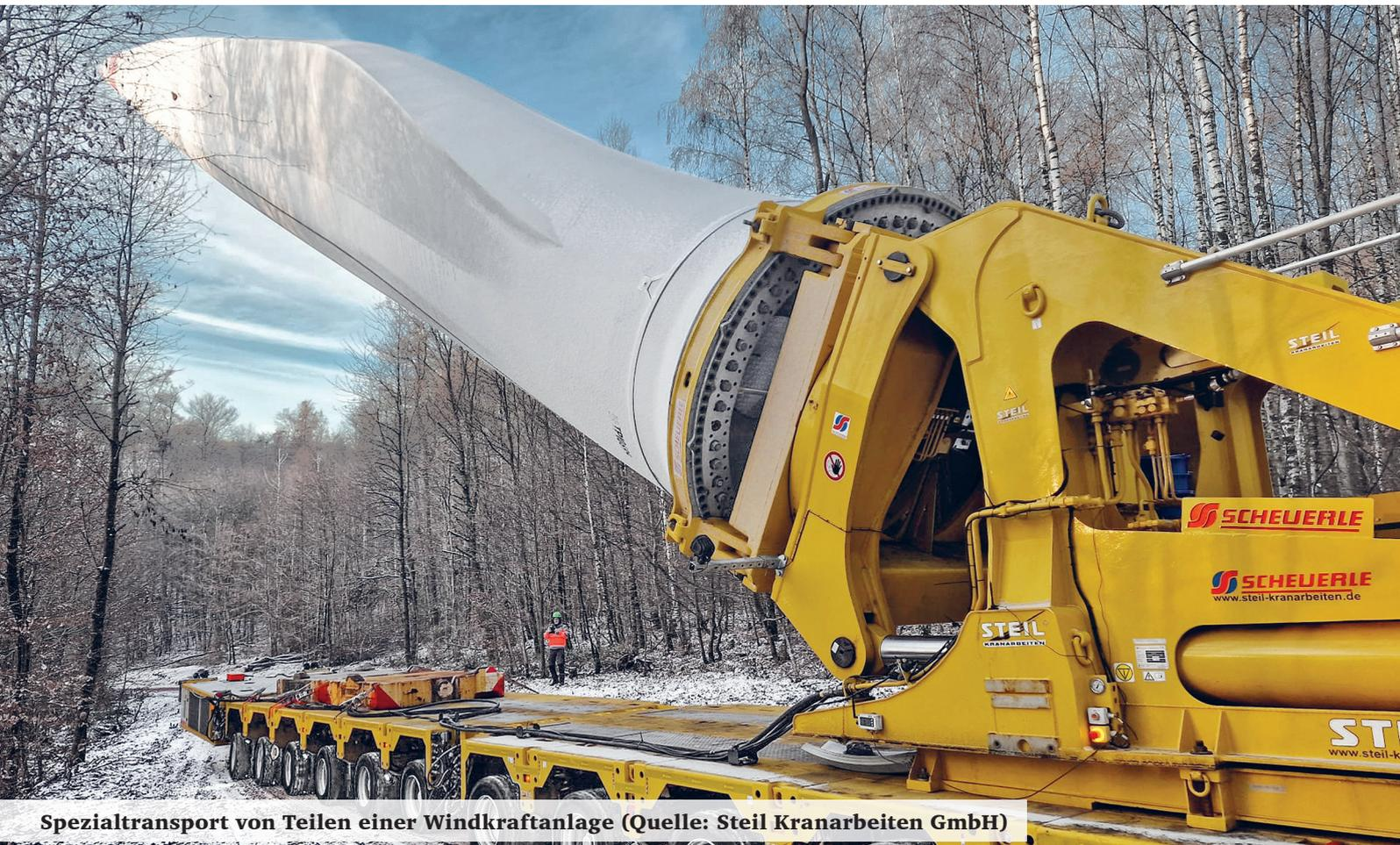
Spezialtransport von Teilen einer Windkraftanlage (Quelle: Steil Kranarbeiten GmbH)
