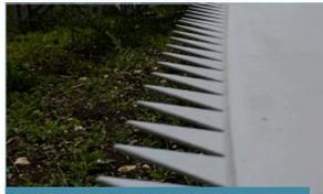
Abb. 3: Hinterkantenkamm am Rotorblatt einer Windenergieanlage. Der Hinterkantenkamm reduziert den Schall durch Verwirbelung. Quelle: Enovos SA.
